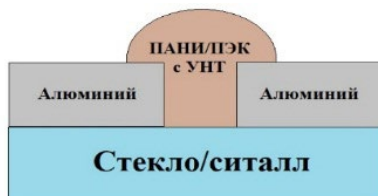
Рис. 1. Структура тонкопленочных резистивных датчиков
