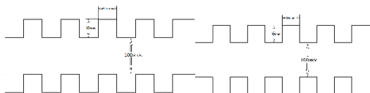
Рис. 1. Расположение тупиковых пор в построенных микроканалах. (а) – со смещением на 50 микрон, (б) – без смещения
