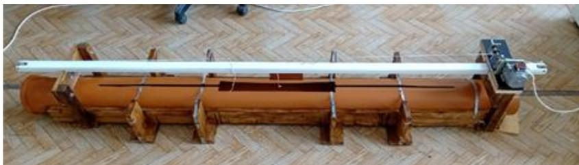
Рис. 1 Внешний вид лабораторного стенда по изучению характера распространения акустических шумов внутри участка горизонтальной скважины
