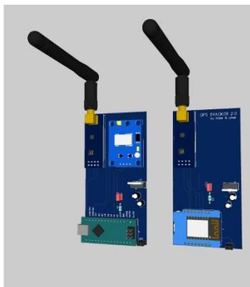
Рис. 2. 3D- модель готового устройства (приемник и передатчик)
