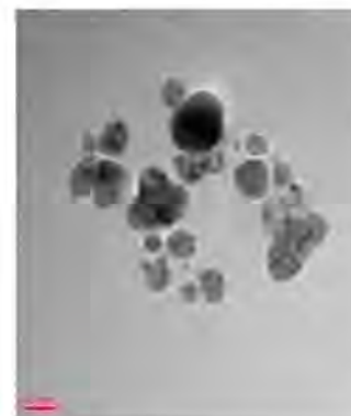
Рис. 3а. Изображение, полученное с помощью ПЭМ, при увеличении 97000. Система 2,5 г Мурр/EtOH+Ag + , Растворы после воздействия дневного рассеянного света
