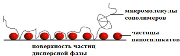
Рис. Схематическое изображение механизма вытеснительной флокуляции.
