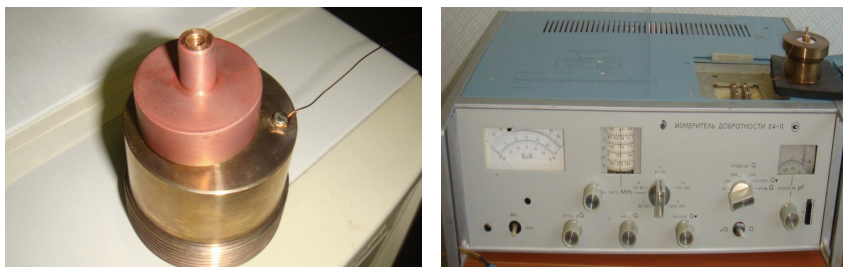
Рис. 2. Конденсатор цилиндрического типа и измеритель добротности (куметр)
