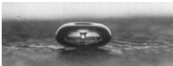
Рис. 6: Фотография пузырька, схлопывающегося у стенки с образованием на его поверхности высокоскоростной струи (сделана Крамом [6]).
