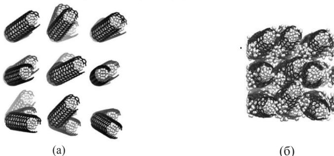
Рис. 1. Структура наводороженного сжатого графена до (а) и после сжатия  $\varepsilon = 0,77$  (б)
