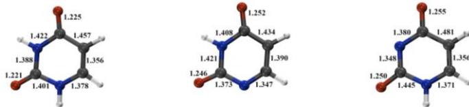
Рис. 1. Структурные изменения молекулы урацила и ее анионов
