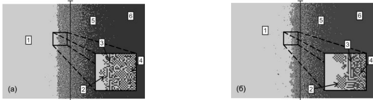
Рис. 2. Результат моделирования по нелинейному закону изменения параметра парного потенциала от концентрации; учет локальной концентрации: (а) – 10 \times 10 , (б) – 40 \times 40 атомов; температура 750^\circ\text{C} ; 1 \times 10^9 элементарных актов диффузии в данном объёме
