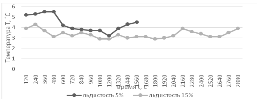
Рис. 3. Изменение температуры воды t на границе вода-грунт при льдистости 5% и 15% и начальной температуре воды t=2,5^{\circ}\text{C}
