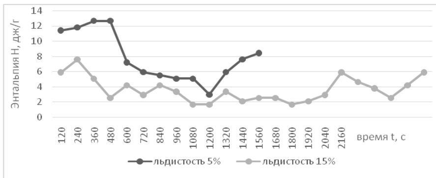
Рис.4. Зависимость теплосодержания воды H от времени t при температуре воды 2,5^{\circ}\text{C}
