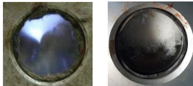
Рис. 2. Фотографии гидрата углекислого газа, полученного в ячейке из нержавеющей стали (слева) и в ячейке из стали марки 45 (справа)
