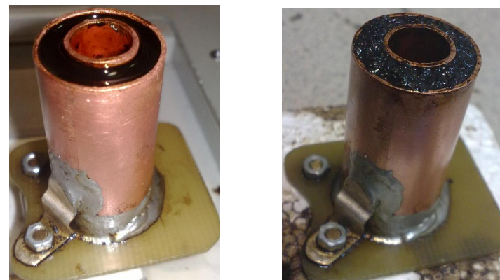
Рис. 1. Фотографии измерительной ячейки, заполненной нефтью (слева) и нефтенасыщенным песком (справа)
