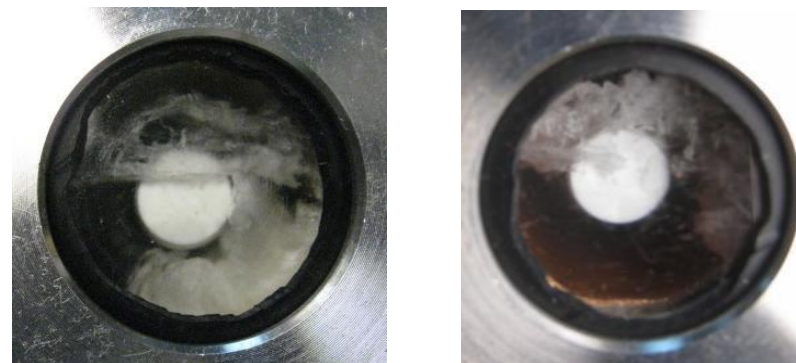
Рис. 3. Фотографии, полученные при образовании гидрата в камере, внутренняя поверхность которой выполнена из бронзы (слева) и меди (справа)
