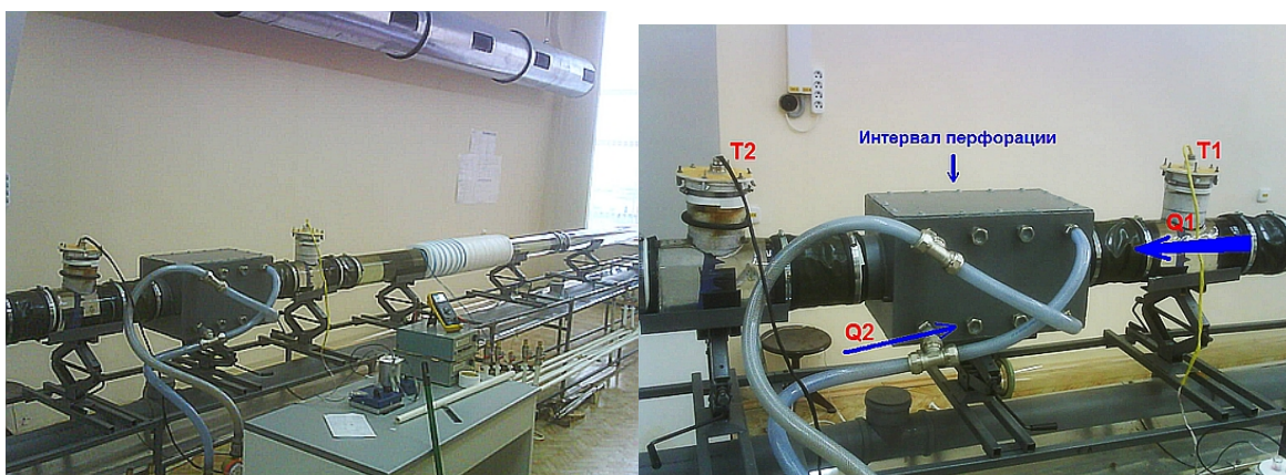
Рис. 2. Внешний вид стенда и участка интервала перфорации.
